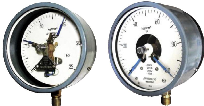
Приборы выполнены в неразъемной конструкции, несанкционированный доступ невозможен.
